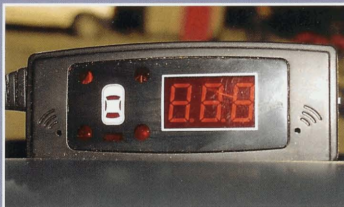
I tillegg til lydsignalet får føreren informasjon på en skjerm på instrumentbordet om hvilken sensor som fanger opp objektet. Dermed kan han lett danne seg et bilde av trafikksituasjonen og hvilke tiltak den krever.
