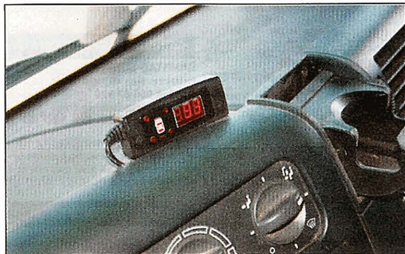
Når man aktiverer blinklysene aktiverer man også sensorene på siden av lastebilen. Hvis et objekt befinner seg i blindfeltet får sjåføren et varsel i form av lyd, samt avstanden til objektet via dette lille displayet.
